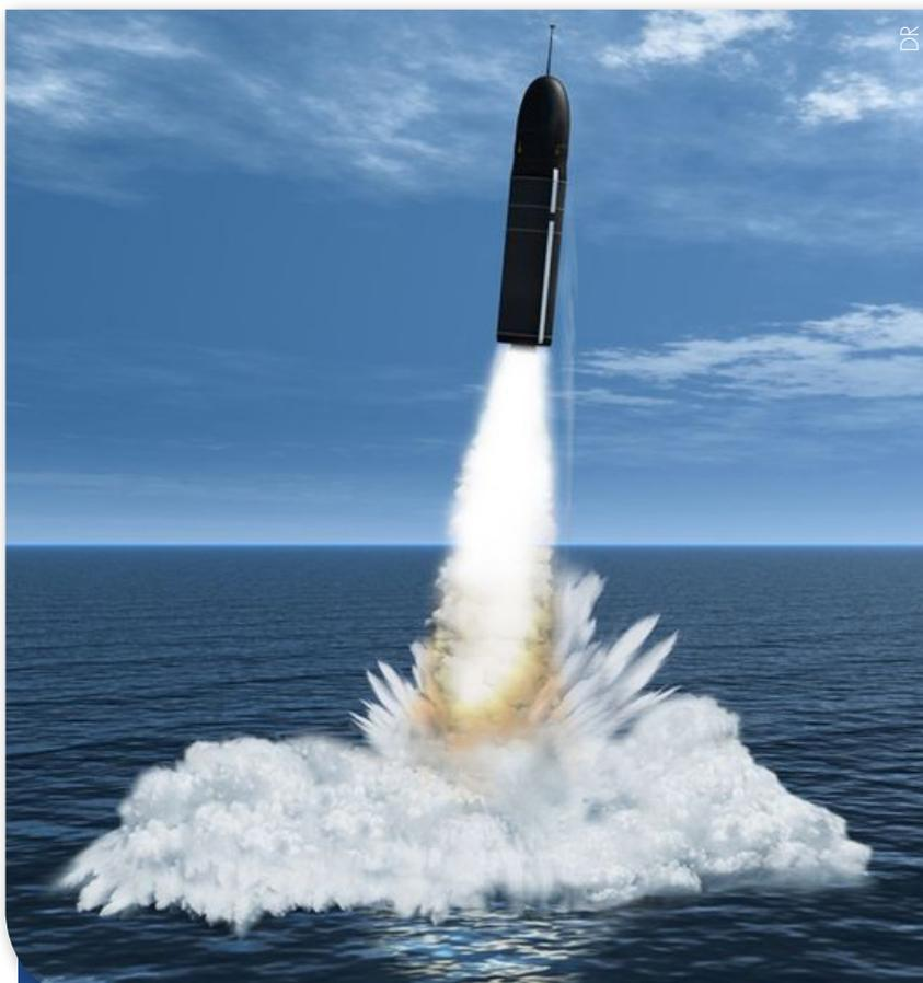
Tir d'essai d'un missile M51. Lançable d'un SNLE en plongée, ce missile à 3 étages pèse plus de 50 t et mesure 12 mètres de hauteur. Il a été mis en service en 2010 à bord du SNLE *Le Terrible*.
