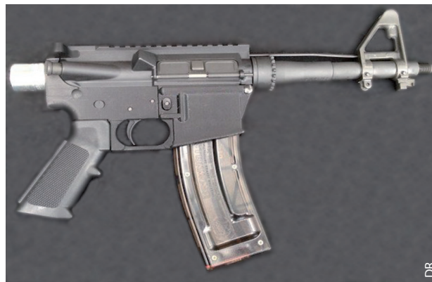
Arme à feu totalement fonctionnelle créée aux Etats-Unis sur une imprimante 3D. L'arme a permis de tirer 200 cartouches sans le moindre problème.
