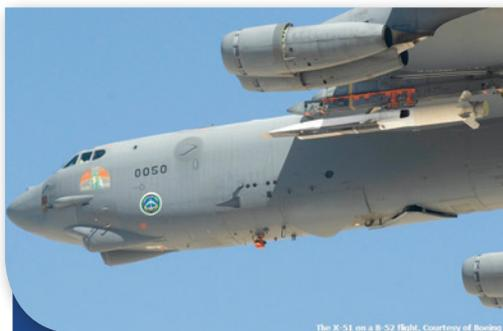
Le missile X-51A Waverider sous les ailes d'un bombardier B-52 qui l'amène à 15 000m d'altitude avant le lancement.
